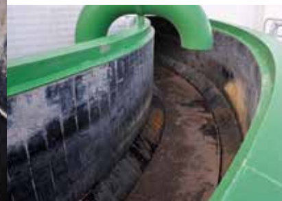
Bietengoot voorzien van Abresist
