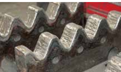
Met WearProtect LTM opgelaste segmenten van een rubbershredder
