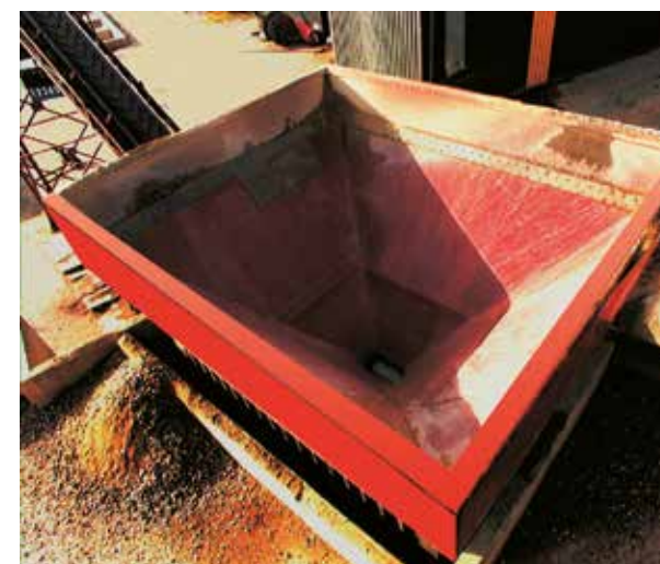
Bunker bekleedt met 40 Shore rubber
