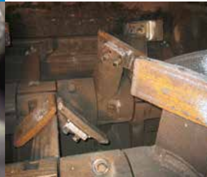
Armen en schoepen in en asfaltmenger voorzien van WearProtect TCO
