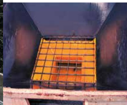
Bunkeruitloop bekleed met WearProtect PU Platen
