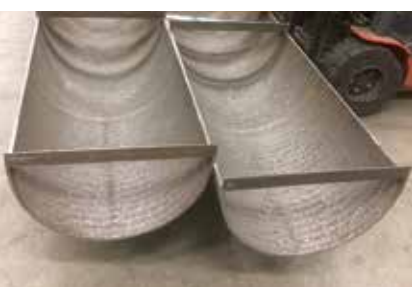
Een rechte leiding, waarbij alleen de onderste helft uit slijtvast opgelaste platen is gemaakt
